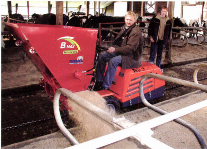
Das Einstreuen des Kalkes kann sowohl für Hoch- als auch Tiefboxen maschinisiert und damit zeitsparend ausgeführt werden. Werkfoto Tuchel
